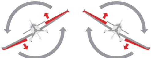
Wenn die Ebene nach links oder rechts gedreht wird (Roll), sollten die Querruder die oben dargestellten Korrekturmaßnahmen aufweisen.
